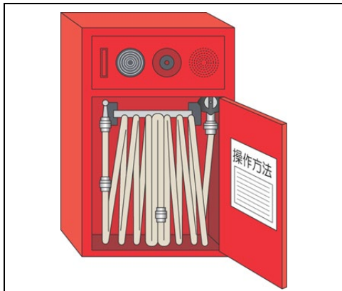
屋内消火栓設備
